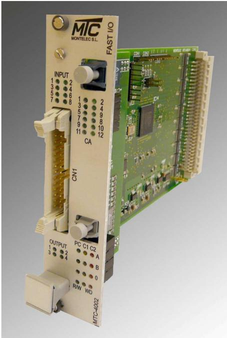
La tarjeta **MTC-4002** es una tarjeta de interrupciones y contadores rápidos diseñada para ser usada tanto en aplicaciones sencillas como en controles complejos en tiempo real.
