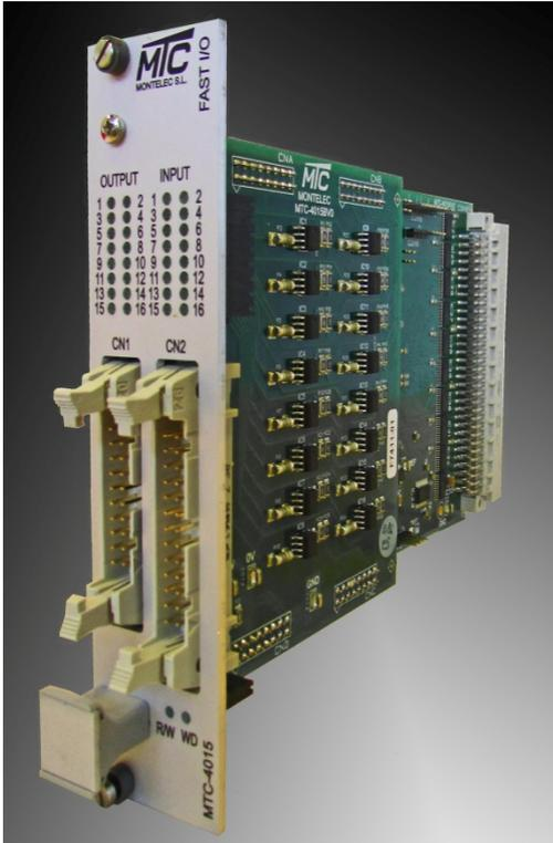
La tarjeta **MTC-4015** es una tarjeta de interrupciones y contadores rápidos configurables, además de entradas y salidas de propósito general. Estos contadores se pueden usar tanto en aplicaciones sencillas como en controles complejos en tiempo real.
