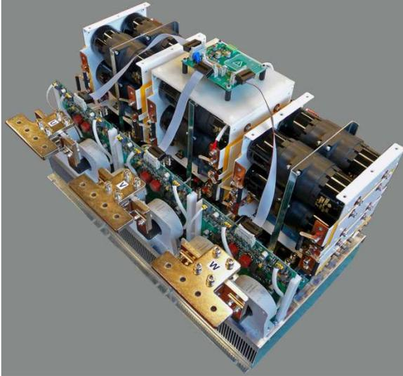
**625 kW IGBT power stack** modular. Fácil de ensamblar en diferentes configuraciones L,H,S.
