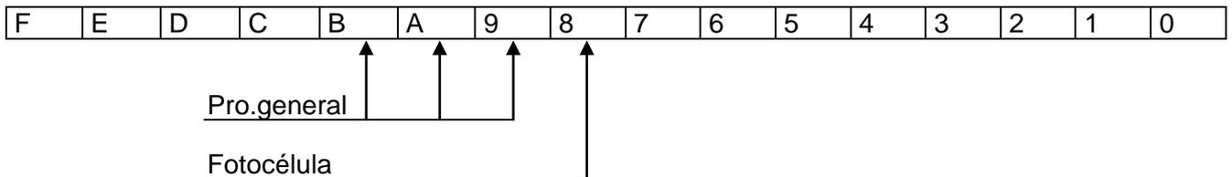
El módulo tiene dos salidas: una dedicada a una electro-válvula y la otra de propósito general.
